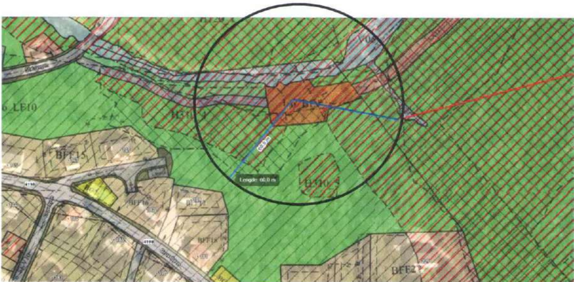
Figur 2 Kastsektor for mindre sprekk eller hull, 60 meter
